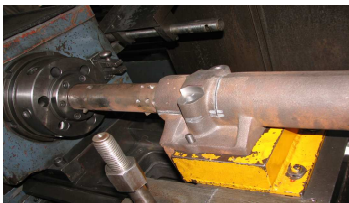
Gambar 3. Proses boring pada mesin bubut
